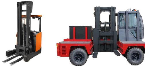
**Catégorie 6 : Chariots élévateurs à poste de conduite élevé (hauteur de plancher  $>$  1,20 m)**
